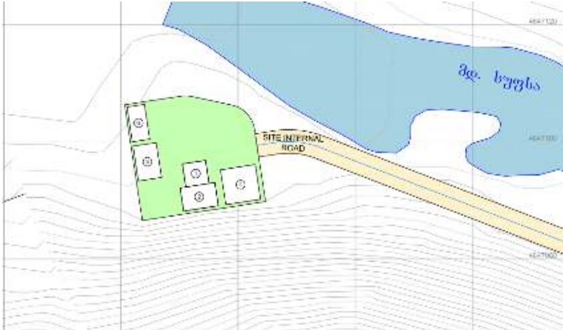
ნახაზი 2.4.3.1. ბეტონის ქარხნის სავარაუდო ადგილმდებარეობის და საჭირო ინფრასტრუქტურის სქემა
